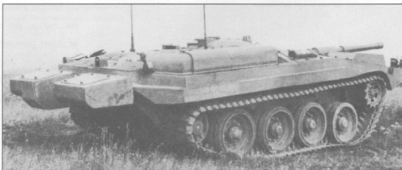
Een van de vóórproductievoertuigen, met in het midden de oorspronkelijke, gewelfde commandantscupola
