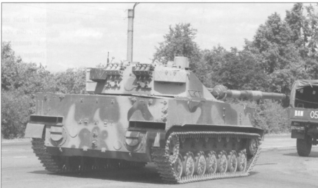
De twee ronde uitgangen van de hydro-jets aan de achterzijde zijn op deze foto duidelijk zichtbaar.
